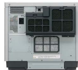
Lüfter sorgen dafür, dass gefilterte Luft zur Kühlung in das Gehäuse kommt. Der permanente Überdruck verhindert, dass Staub ins Innere gelangt.
